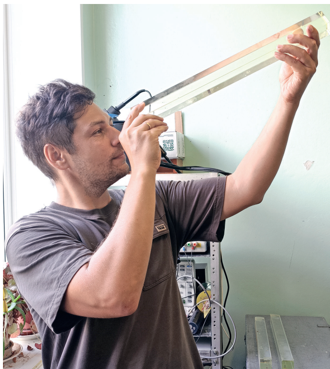
Визуальная проверка стёкол электромагнитного калориметра на прозрачность
